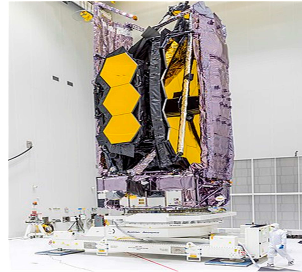
Fig. 5 : « James Webb » entièrement replié en salle blanche, à Kourou, avant sa mise en place dans la fusée Ariane. Le personnage à droite en bas donne l'échelle.
