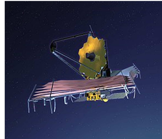
Fig. 4 : Maquette du télescope James Webb. Le bouclier thermique déplié a la taille d'un terrain de tennis
